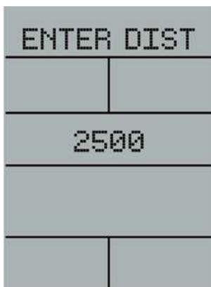
В режиме настройки программы необходимо установить дистанцию. Минимальное значение составляет 100 метров, максимальное 99900 метров. Предустановленное значение равно 2500 метров. Регулировка дистанции производится кнопками UP и DOWN. Каждое последовательное нажатие кнопки UP или DOWN увеличивает / уменьшает значение с шагом в 100.
