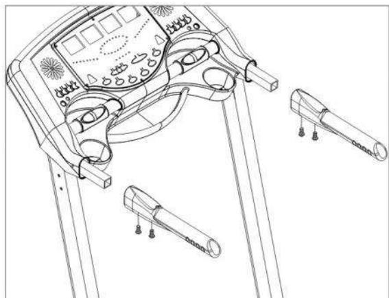
**Установите поручни и зафиксируйте болтами №6 и ключом №1.**
