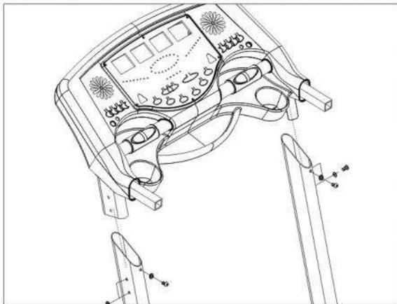
**Установите консоль на стойки тренажера, соединив предварительно провода в правой стойке. Будьте внимательны – не пережмите кабели! Зафиксируйте консоль с помощью болтов №3 и ключа №1.**
