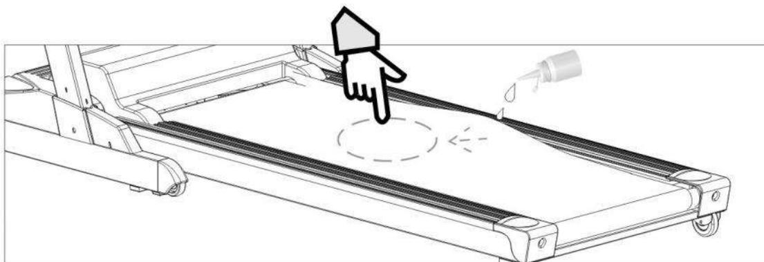
**Для смазки бегового полотна поднимите полотно и нанесите силиконовую смазку в промежуток между полотном и декой.**
