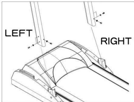
**Установите левую и правую стойки на основную раму. Предварительно пропустите провод через правую стойку и соедините коннектор провода с коннектором из рамы тренажера. Будьте внимательны – не пережмите кабели! Зафиксируйте стойки с помощью болтов №3 и ключа №1.**
