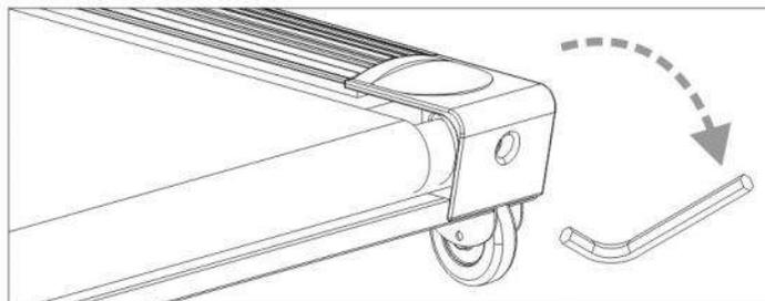
4. Поворачивайте левый регулировочный болт по часовой стрелке, если хотите сдвинуть полотно вправо
