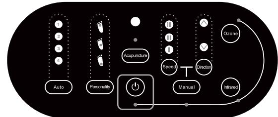
2. (Auto)-Taste automatisierte Software-Management. Insgesamt gibt es 4 automatische Programme. Mit jedem Tastendruck wird das automatische Programm zu überspringen, und die entsprechende LED leuchtet. Wenn das Produkt nicht in den anderen Modi zu arbeiten, drücken Sie diese Taste, um den automatischen Modus zu gelangen.
