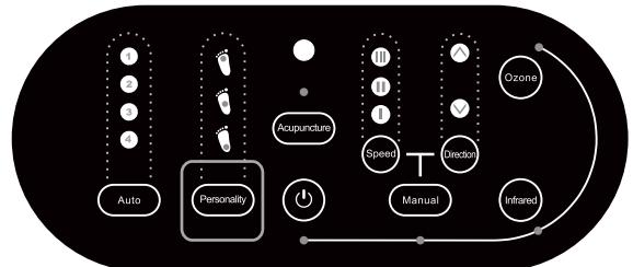
4. (Manuell) Verwenden Sie die Taste manuellen Installation die "Geschwindigkeit" und "Richtung" steuern können. Massagegerät hat 3 Geschwindigkeiten: niedrig, mittel und hoch. Kontrollleuchten der unterschiedlichen Geschwindigkeiten in einer anderen Farbe. Im Uhrzeigersinn und gegen den Uhrzeigersinn - Die Richtungstasten können zwei Stufen eingestellt werden.
