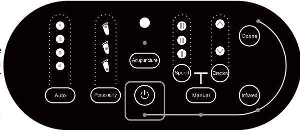
2. (Auto) Кнопка автоматического программного управления. Всего имеется 4 автоматических программы. Каждое нажатие приводит к переходу на автоматическую программу, и загорается соответствующий светодиод. Когда изделие работает в других режимах, нажмите на эту клавишу, чтобы войти в автоматический режим.
