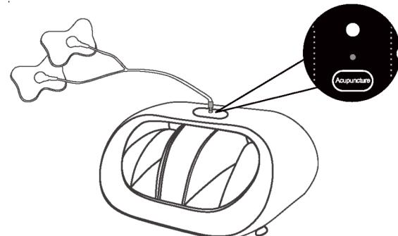
Führen Sie die Drähte in die Socket-Schnittstelle Panel.
