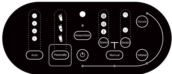
4. (Manual) Клавишей ручной установки можно контролировать "скорость" и "направление". Массажер 3 скорости: низкую, среднюю и высокую. Контрольные лампы разных скоростей имеют разные цвета. Клавишей направления можно задать два уровня - по часовой стрелке и против часовой стрелки.
